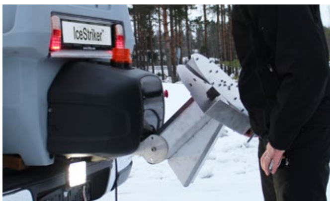
Uppfällbart spridartorn i rostfritt stål.
