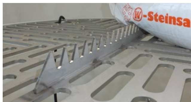
Taggig skärkant för öppning av saltsäckar
